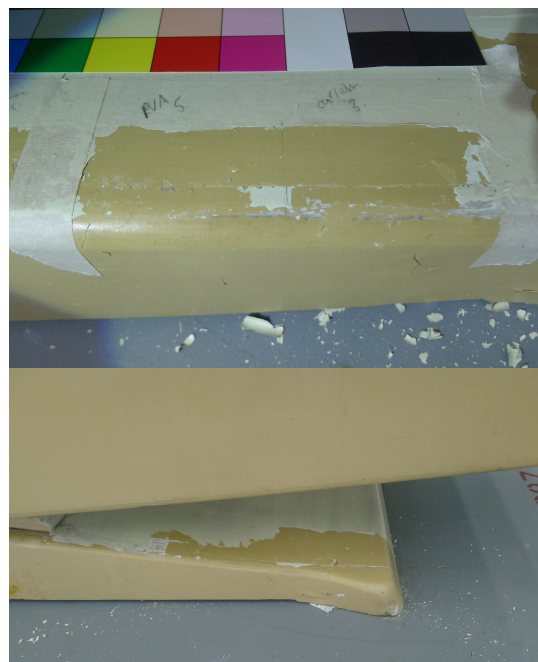
Afb. 13: Resultaten van de tests met PVAc gel 5 en de Carbopol/ Ethomeen gel 2 (boven). Waarna de toepasbaarheid op een groter oppervlak getest is met PVAc gel. (onder. (Foto's: Auteur, mei 2016).
